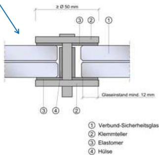
Abbildung 4: Querschnitt Tellerhalter
