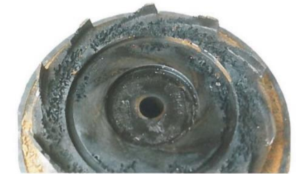
Kavitationserosion am Diffusor einer mehrstufigen Kreiselpumpe.
