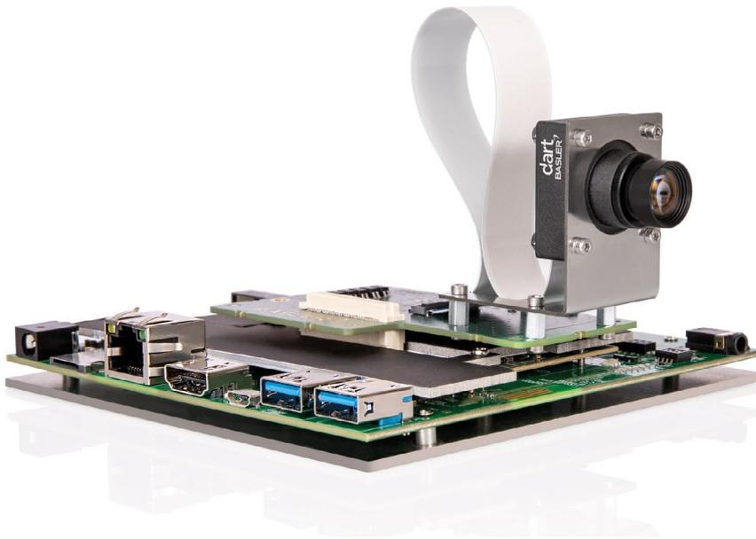
**Baslers neues Embedded Vision Kit enthält das erste Kameramodul, das den unübertroffenen Image Signal Prozessor des Snapdragon SoC von Qualcomm unter Linux nutzt. Dieses innovative Produktkonzept reduziert die Gesamtprozessorlast des Systems deutlich und gibt so mehr Rechenleistung für die eigentliche Anwendung frei.**
