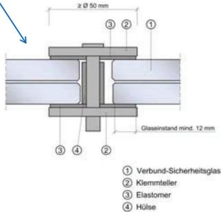
Abbildung 4: Querschnitt Tellerhalter
