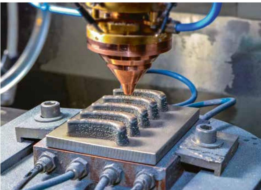
Mittels Laser-Pulver-Auftragschweißen lassen sich Bauteile aus verschiedenen Materialien integral fertigen. So können spezifische Materialien an genau den Orten platziert werden, wo ihre Eigenschaften benötigt werden. Dies stellt beispielsweise leichtere, bessere und kostenreduzierte Schaufeln für Gasturbinen in Aussicht.
