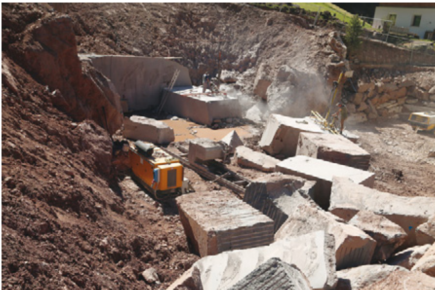
Den Steinen auf der Spur: Mitarbeiter der südtirol.stein GmbH zerlegen einen GRÖDNER PORPHYR LAYON-Findling.
