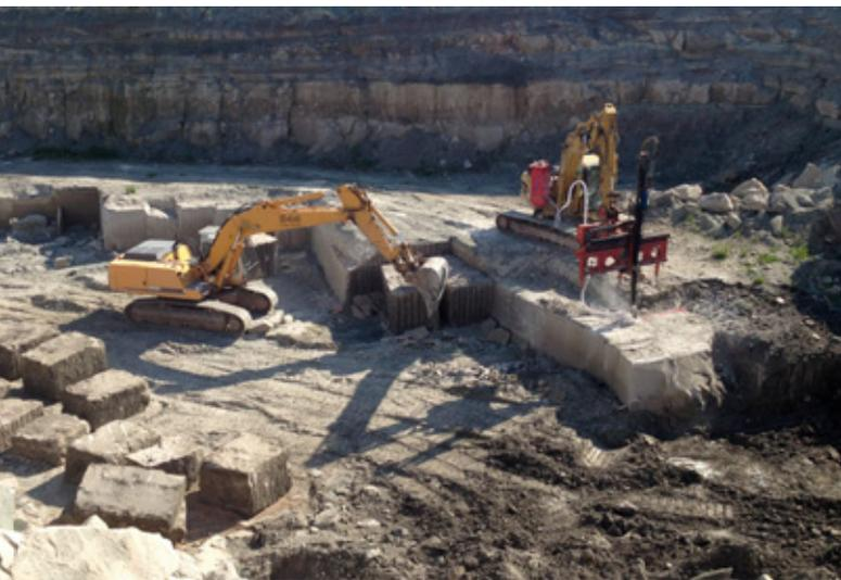
Abbau von weißgrauem MAINSANDSTEIN im Hahnbruch bei Eitmann, den das Bamberger Natursteinwerk vor ein paar Jahren von der Firma Vetter übernommen hat.
