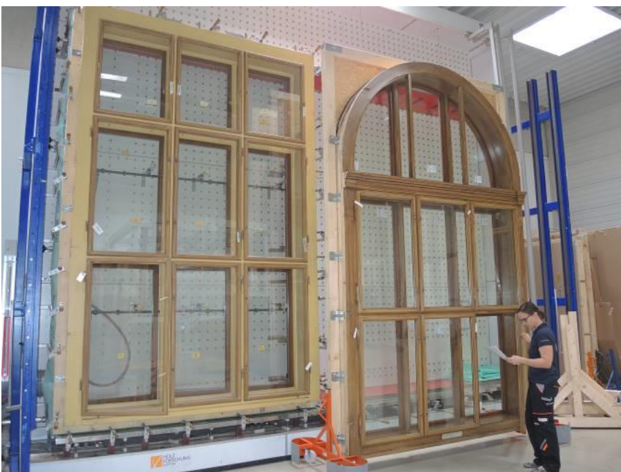
BU: Historisches Fenster auf dem Prüfstand der Holzforschung Austria.
