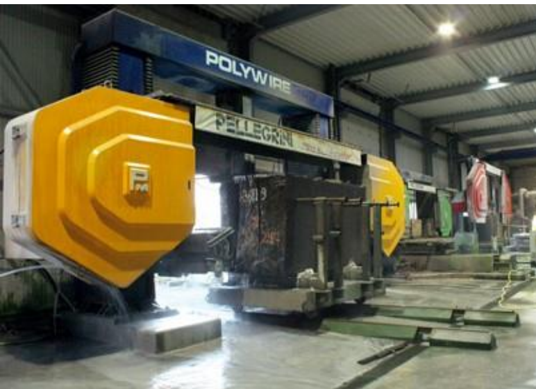
Rohplattenproduktion mit einer Multiwiresäge bei Just in Hartha
