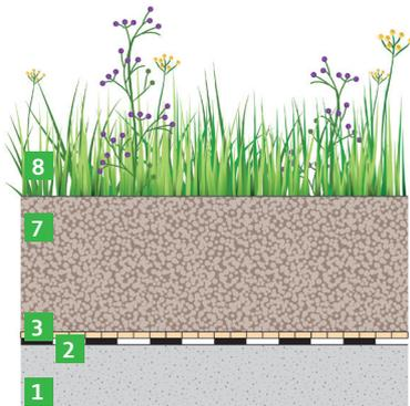
Abb. 13: Schematische Darstellung einer einschichtigen Dachbegrünung. Quelle: BuGG
